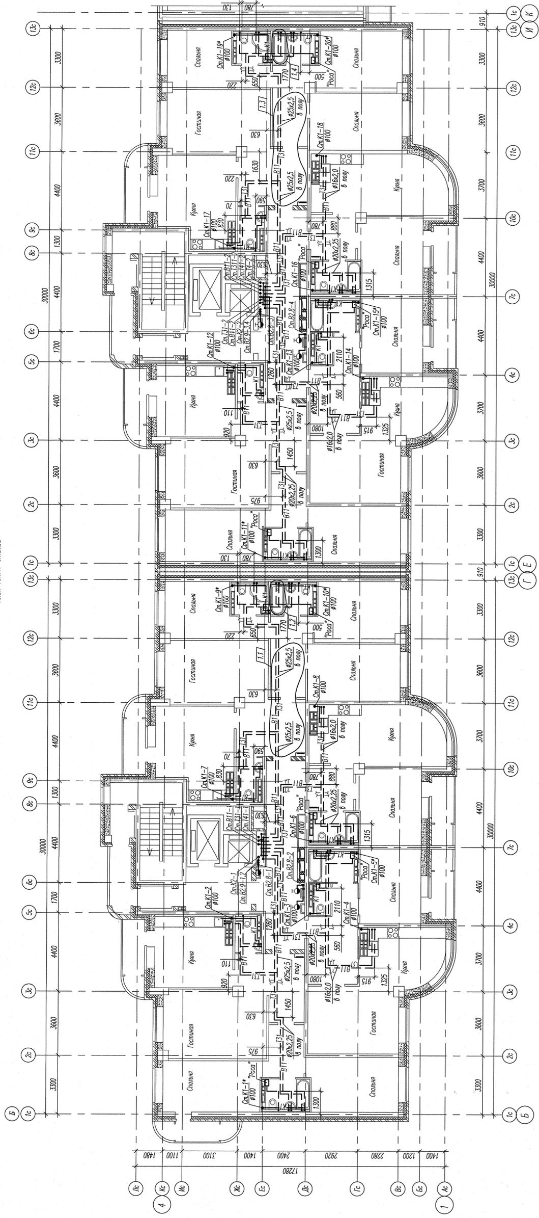
План размещения квартирных водомерных узлов в общей нише
