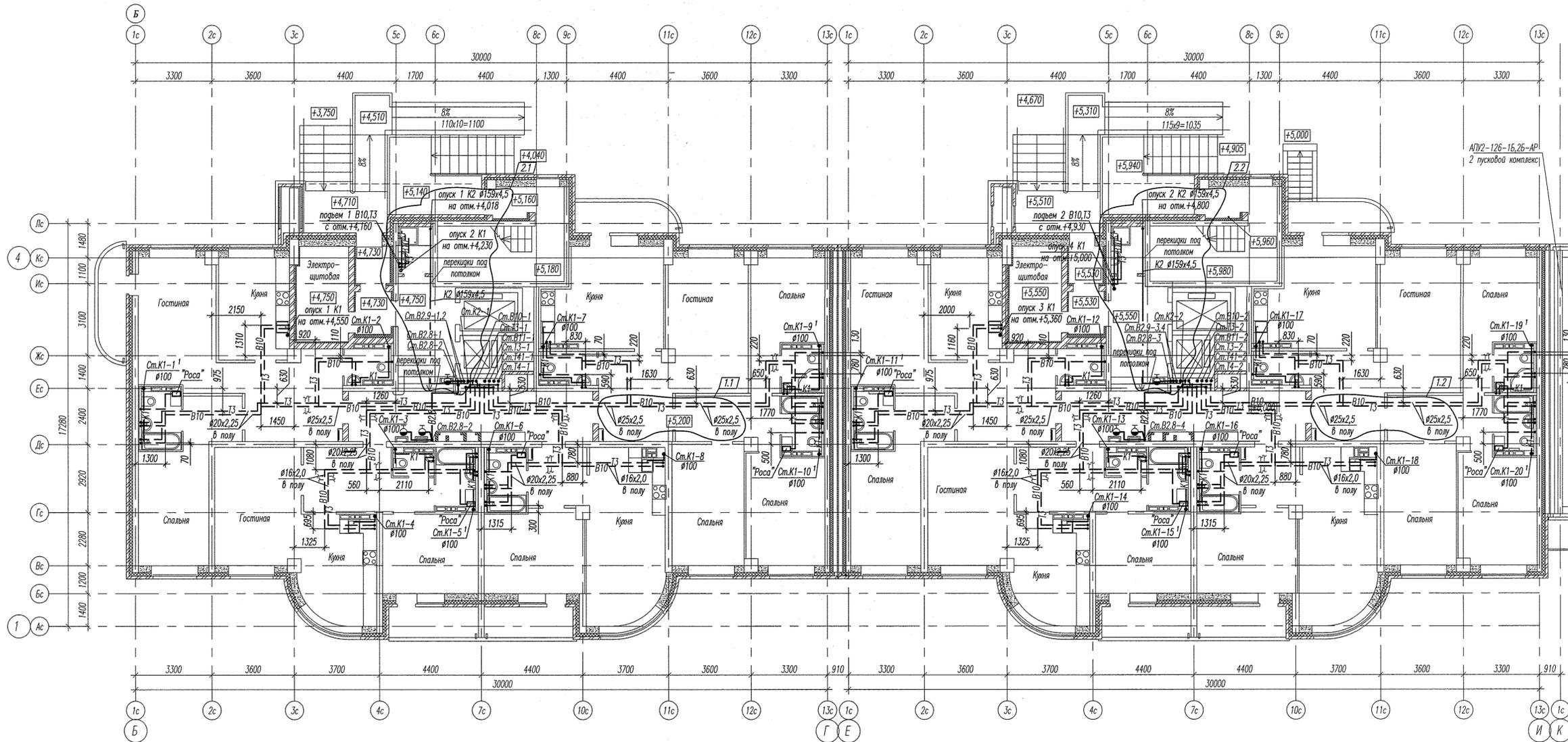
План размещения квартирных водомерных узлов в общей нише
